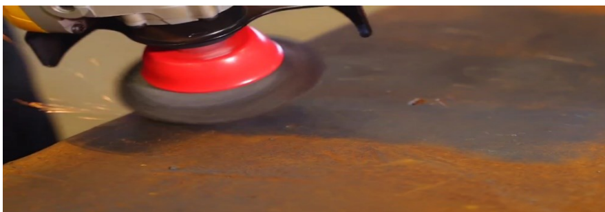
Figura 4 - Superfície sendo esmerilhada
