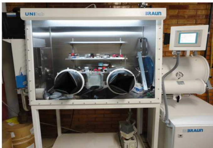
Figura 2.1 - Câmara seca ( glovebox ) MBraun. [elaborada pela autora]
