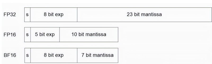
Figura 3.1: Comparação dos formatos de representação em ponto-flutuante, extraído de (Intel, 2018)
