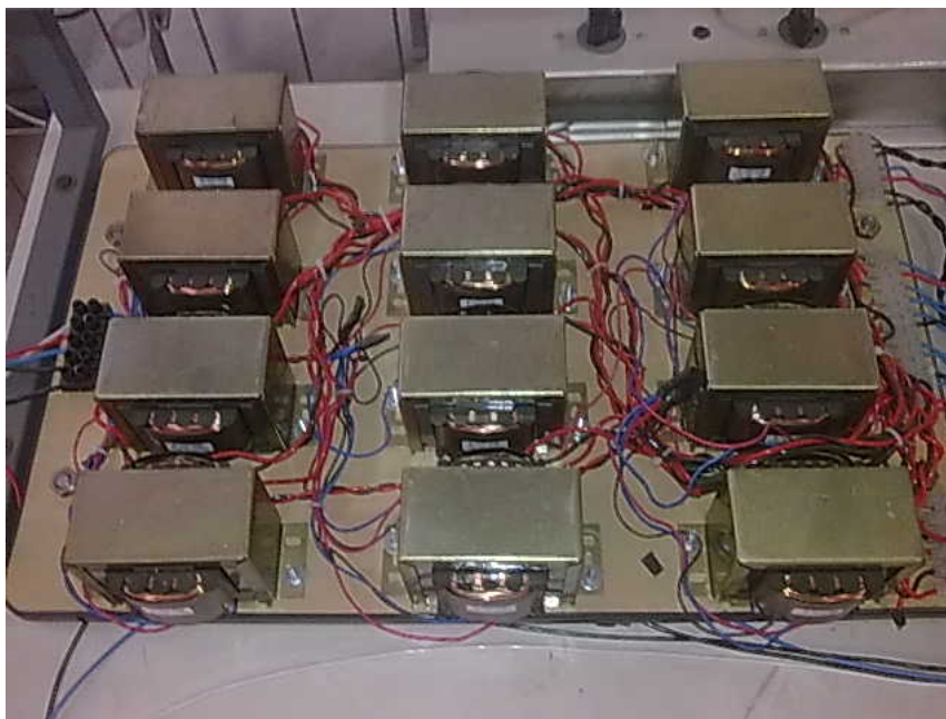
Figura 4.55: Detalhe Protótipo do CST em Ona Quadrada - topologia Multinível em Cascata - Trifásico - Transformadores Shunt
