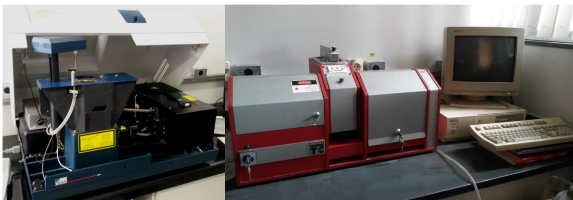
Figura 4.2: Granulômetro Cilas e granulômetro Sympatec, respectivamente.
