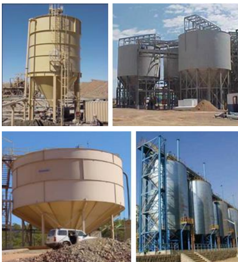
Figura 3.11: Espessador Deep Cone (Jewell, 2002; Fogwill, 2005; Tão et. al. , 2008).
