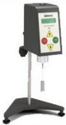
Figura 4.5: Reômetro Brookfield, modelo YR-1, utilizado para determinação da tensão de escoamento.
