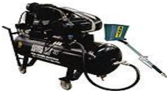
Fig. 20 – Bomba de projeção e compressor
