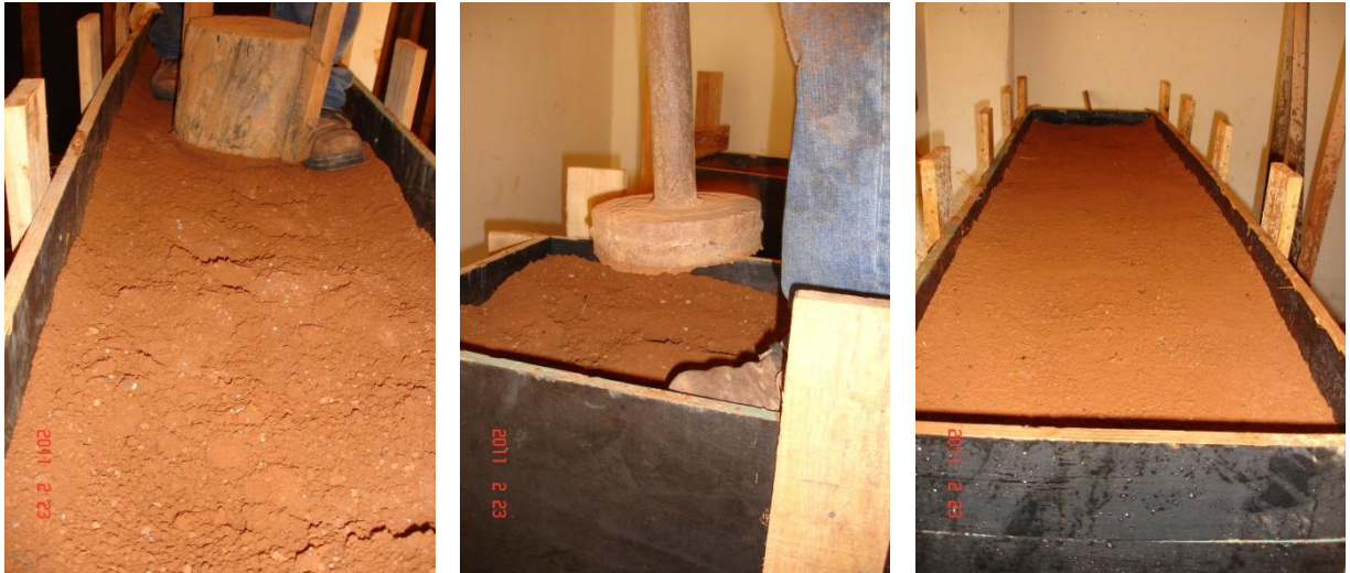
FIGURAS 55, 56 e 57 – Compactação do painel 4
