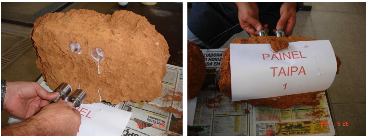
FIGURAS 80 e 81 – Ensaio no corpo de prova do painel 1 – Painel defeituoso
