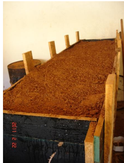
FIGURAS 44 e 45 – Compactação do painel 2
