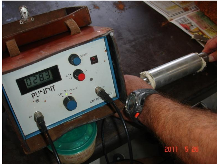
FIGURA 65 – Calibração do equipamento ultrassom
