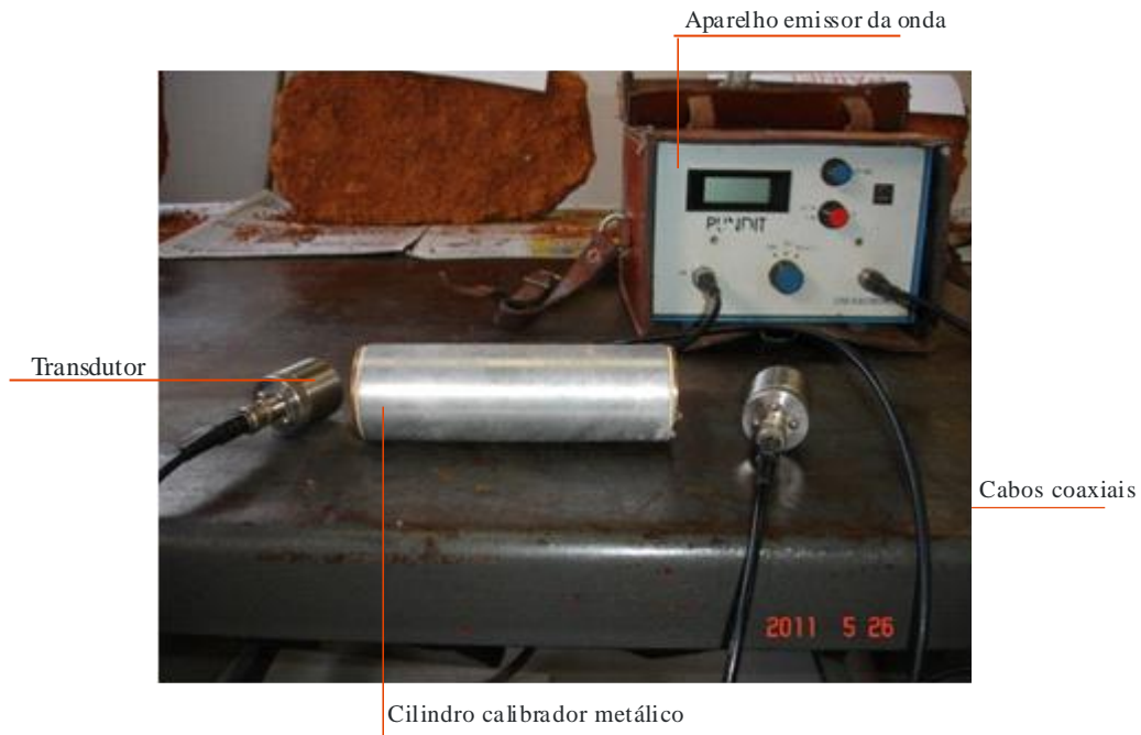
FIGURA 64 – Equipamento utilizado nos testes – PUNDIT
