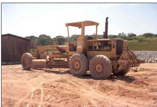
Figura 6 - Equipamento para espalhamento e nivelamento (motoniveladora) Fonte: PACHECO, 2008
