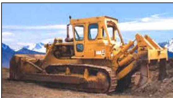
Figura 2 - Equipamentos usados na limpeza: tratores de esteira (bull-dozer) Fonte: PACHECO, 2008
