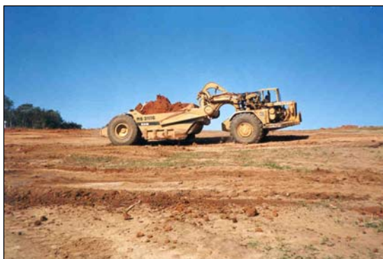
Figura 5 – Equipamento para corte e transporte (motoscraper) Fonte: PACHECO, 2008
