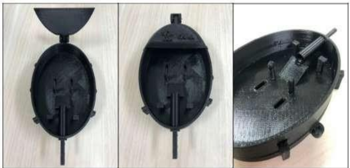
Figura 1 – Mesa cirúrgica personalizada confeccionada através da impressão 3D.
