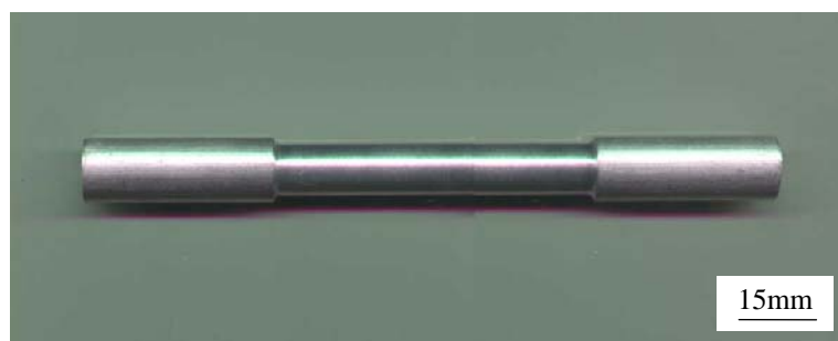
Figura 4.9 - Fotografia do corpo de prova submetido ao ensaio de tração - metal recozido.
