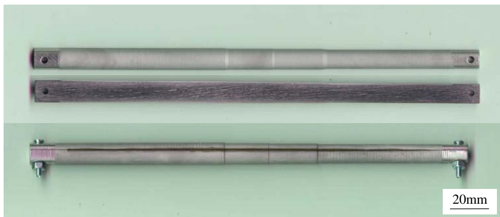
Figura 4.15 - Fotografia dos corpos de prova de visioelasticidade separados e unidos.
