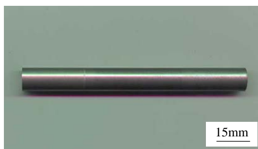
Figura 4.11 - Fotografia do corpo de prova submetido ao ensaio de tração - metal trefilado.
