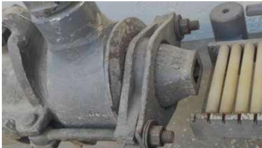
Figure 4.10 – Bocal da máquina extrusor
