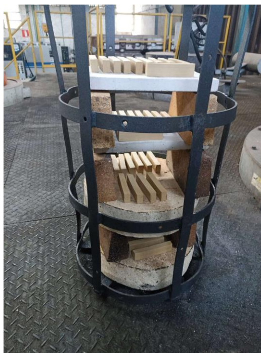
Figure 4.15 – Cesto utilizado para acomodar os corpos de prova no forno
