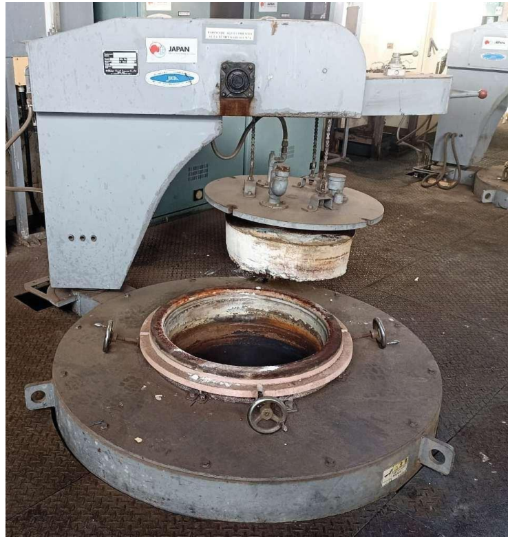
Figure 4.15 – Cesto utilizado para acomodar os corpos de prova no forno
