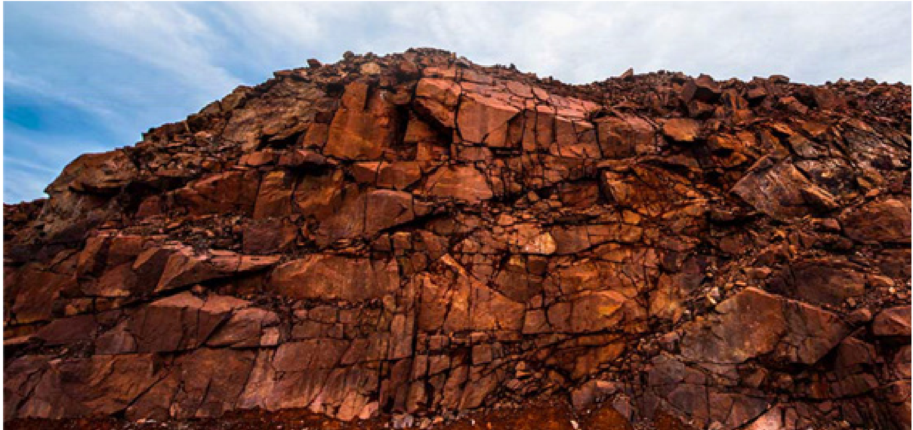
Figura 5 – Visualização do grau de fraturamento da rocha da mina de Pitinga (contribuição do autor, 2019).
