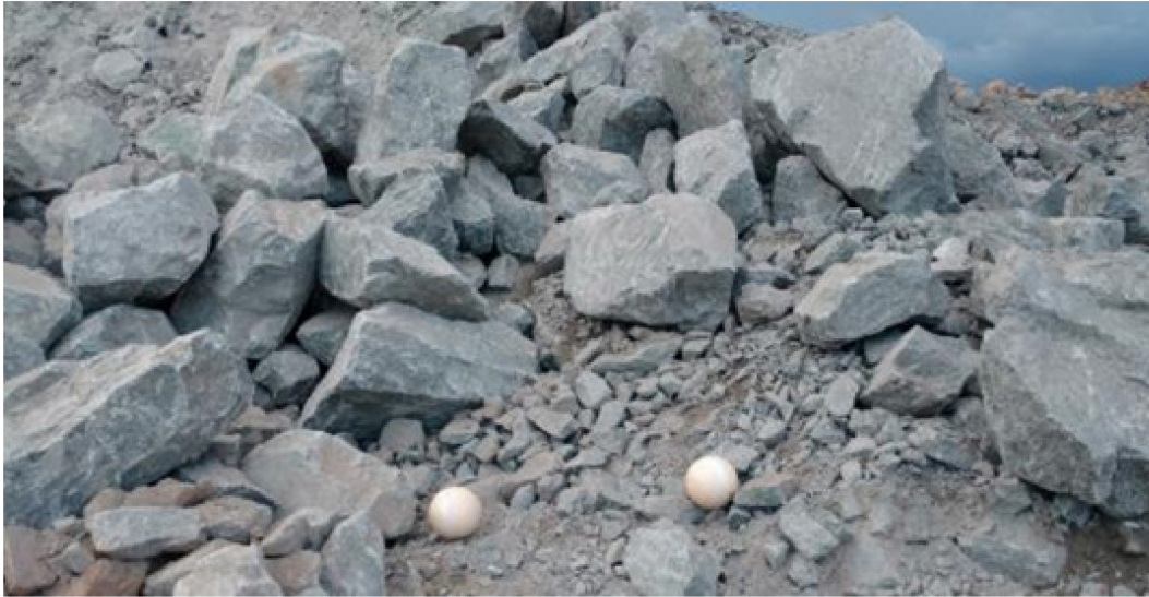
Figura 25 - Pilha de material desmontado com malha antiga
