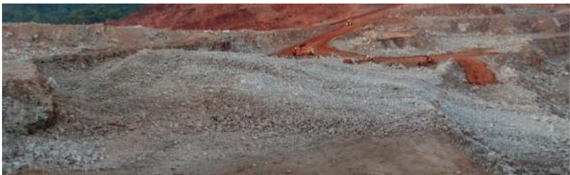
Figura 24 - Pilha de material desmontado
