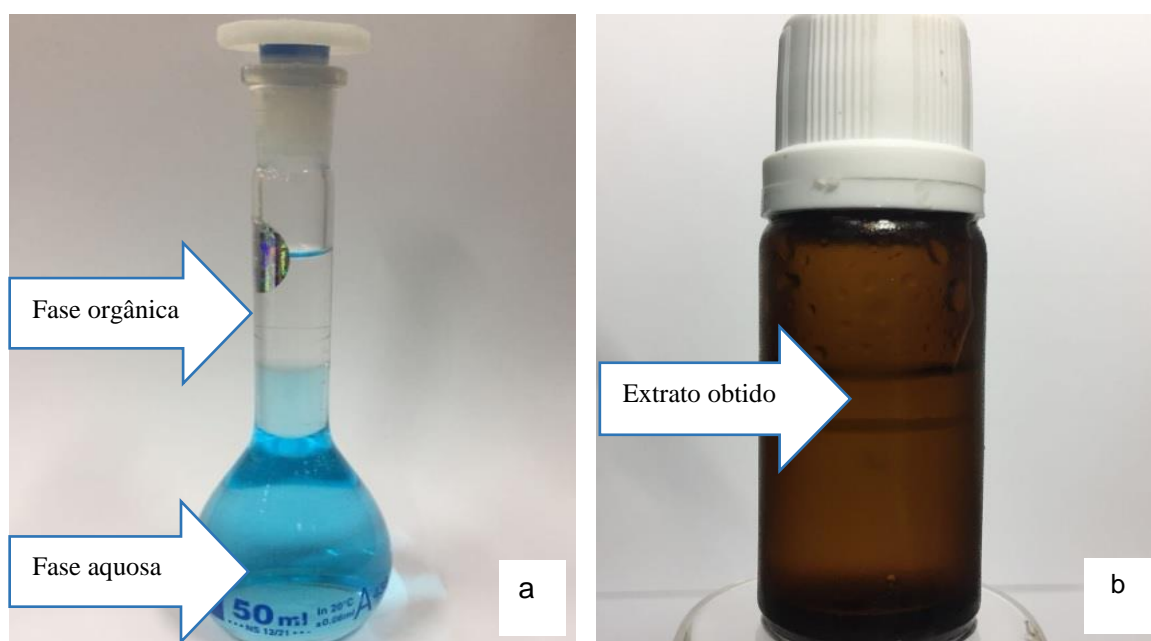
Figura 5.10 - (a) Extração dos AHAs e (b) extrato obtido após a etapa de derivatização
