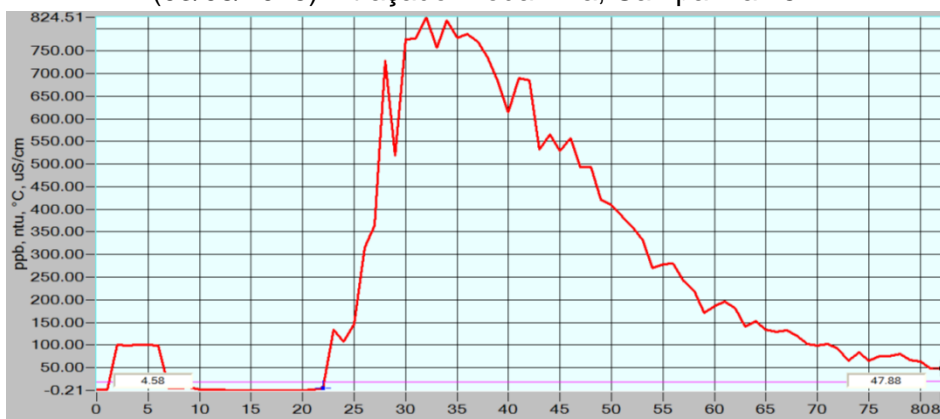
Figura 46 – Recuperação de massa a montante da seção V1 – vazão de 2,4 \text{ L.s}^{-1} . (03/08/2015) – traçador: rodamina, Campanha #5.
