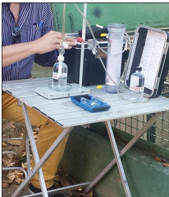
Figura 25 – Análise de ^{222}\text{Rn} próximo ao local de coleta.
