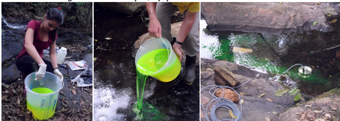
Figura 19 – Calibração, injeção e leitura com o fluorímetro.
