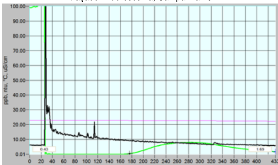
Figura 60 – Recuperação de massa no trecho V1 – vazão de 2,59 \text{ L}\cdot\text{s}^{-1} . (10/05/2016) traçador: fluoresceína, Campanha #8.
