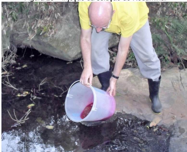
Figura 23 – Injeção da solução de Rodamina.
