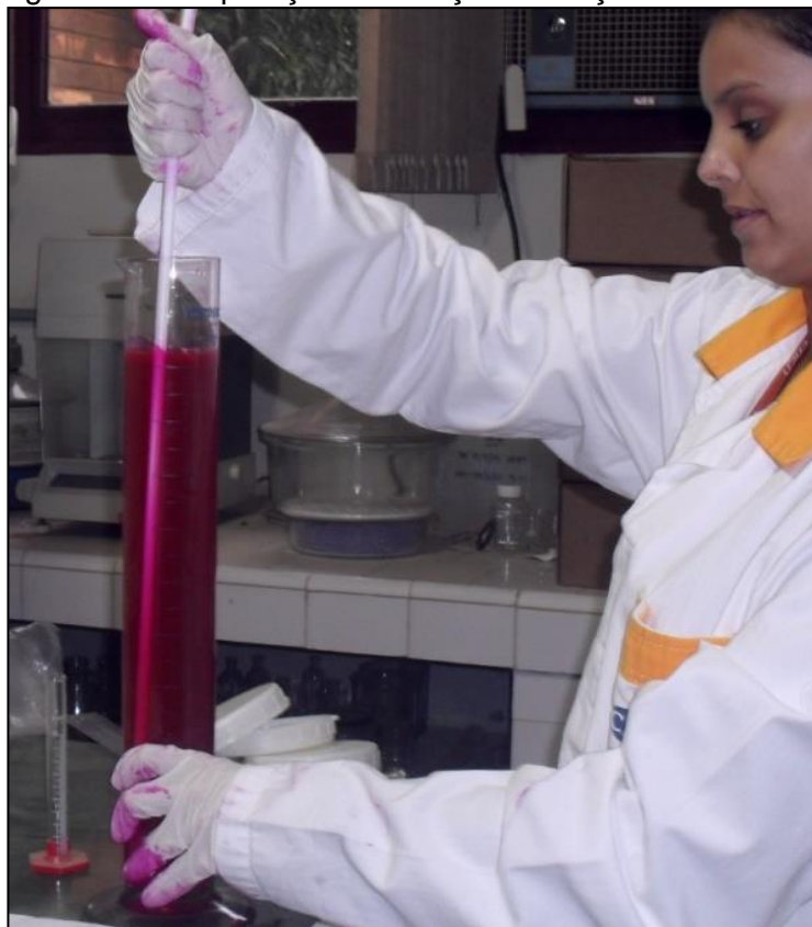
Figura 21 – Preparação da solução do traçador Rodamina
