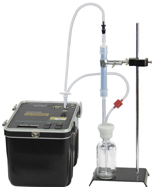
Figura 17 – Kit RAD H2O conectado ao RAD7.
