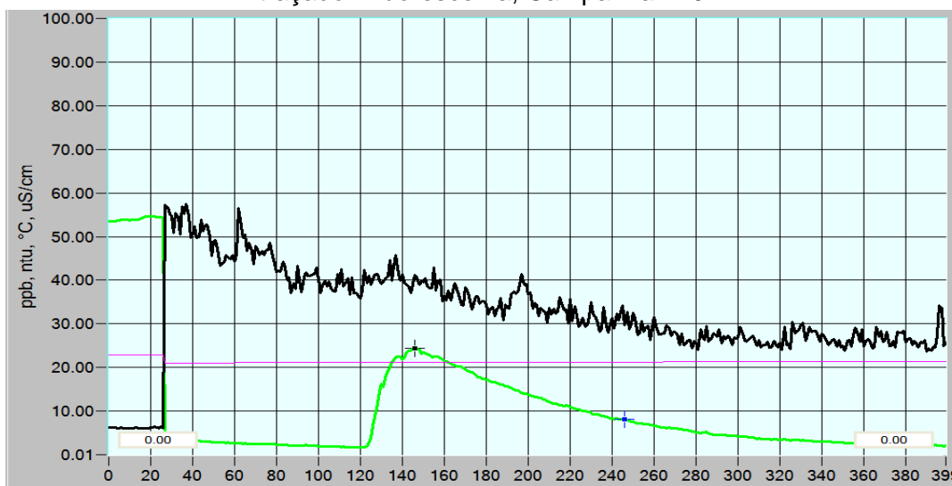
Figura 63 – Recuperação de massa na seção V2 – vazão de 1,83 litros/seg. (24/05/2016) traçador: fluoresceína, Campanha #10.
