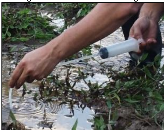
Figura 13 – Coleta com seringa.
