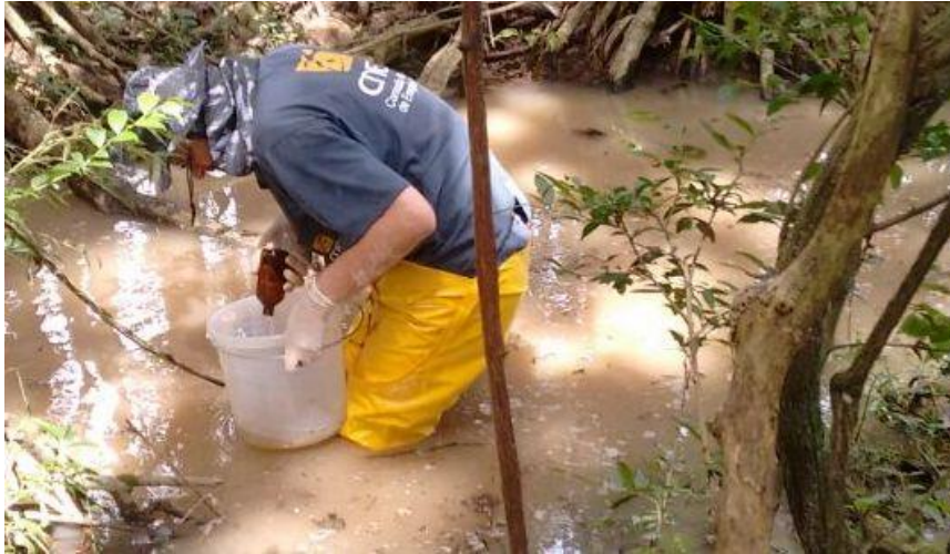
Figura 52 – Excesso de turbidez na água de calibração do fluorímetro.
