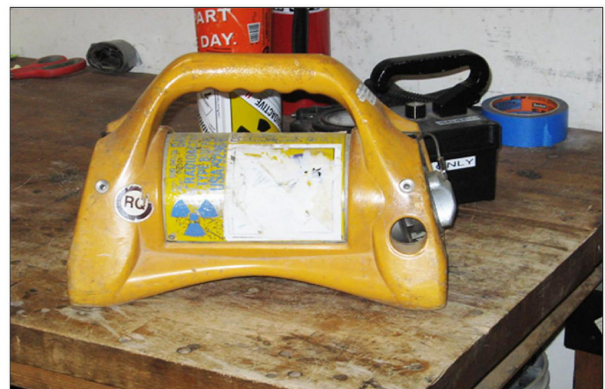
Figura 4 – Fonte típica utilizada em aplicações de radiografia industrial
