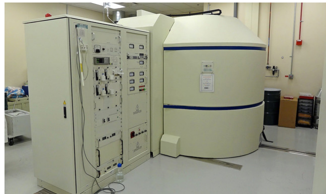
Figura 6 – Acelerador de partículas do tipo cíclotron
