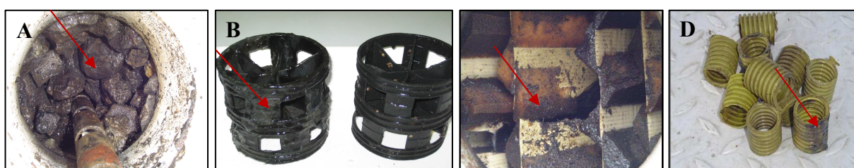
Figura 4.3. Biofilmes aderidos aos materiais suporte (seta vermelha). A) escória de alto-forno; B) anéis plásticos; C) DHS ( Downflow Hanging Sponge ); D) aparas de conduíte.
