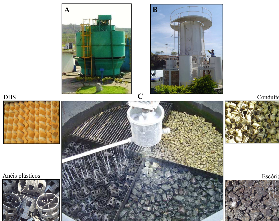
Figura 4.1. Aparato experimental utilizado na pesquisa: sistema UASB/FBP. A) Reator UASB; B) FBP; C) Visão superior dos FBP - materiais suporte.
