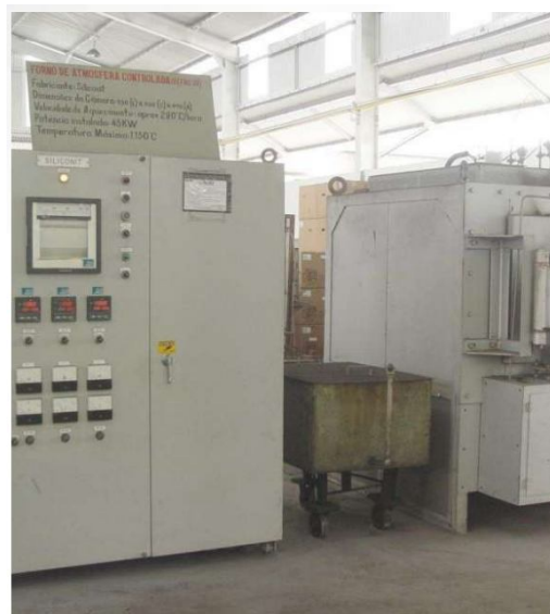
Figura 4.3. Forno piloto FAC III – SILICONIT e controladores YOKOGAWA UP351.
