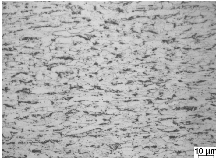
Figura 5.12. Microestrutura obtida para amostra recozida por 6 h – 622°C (CT1).
