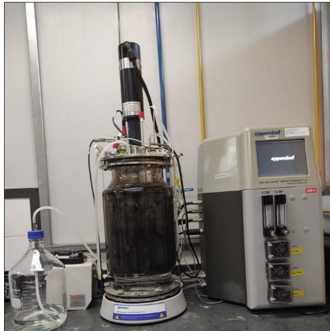
Figura 4.2 - RBS em escala de bancada – Laboratório de Microbiologia – DESA/UFMG
