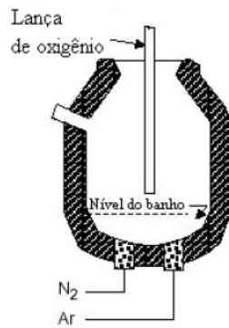
Figura 3.2 - Representação esquemática do Conversor LD com sopro combinado (FRUEHAN, 1998)
