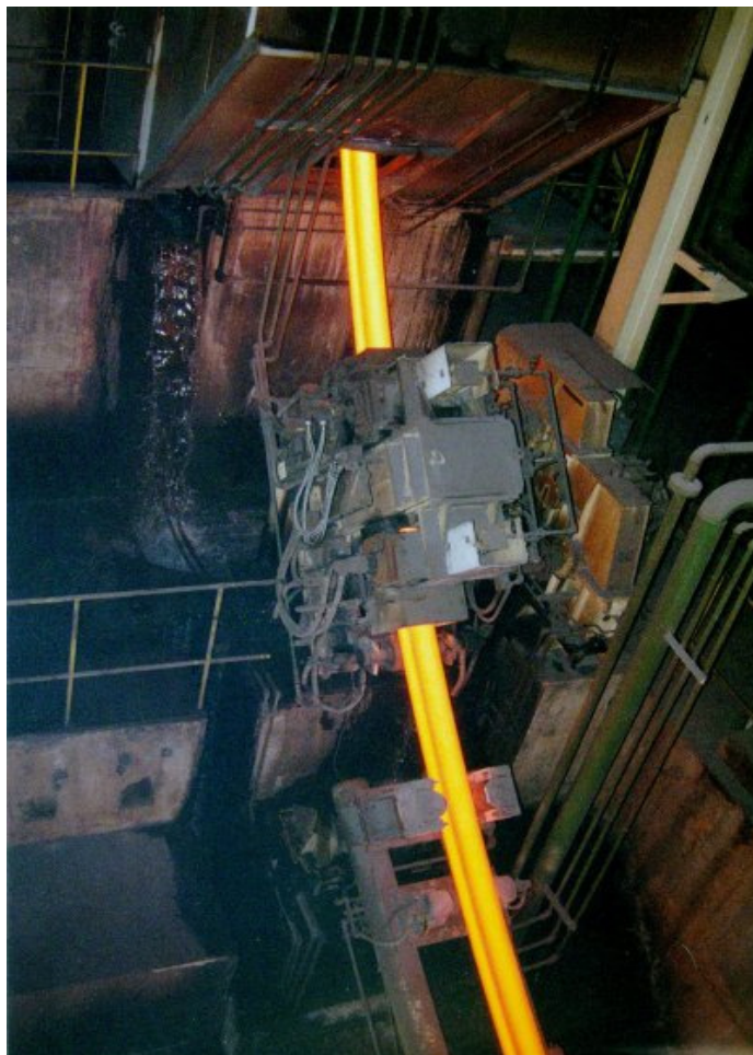
Figura 3.5 - Solidificação do aço em máquina de Lingotamento Contínuo
