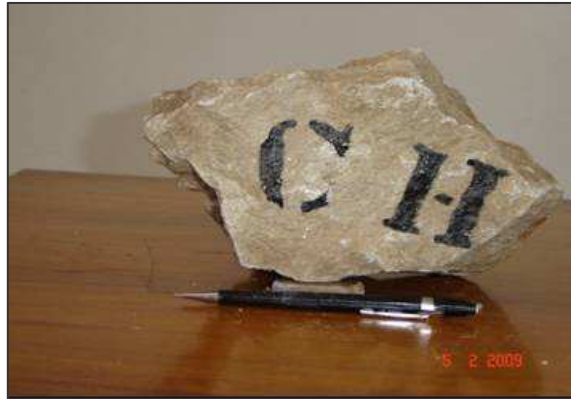
FIGURA 16 - Foto da amostra típica do quartzito pirofilitico com cloritoide (chumbinho).
