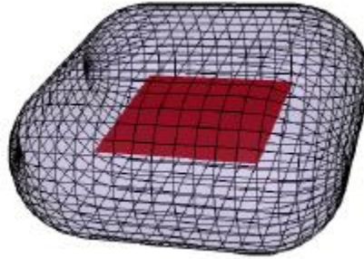
Figura 2.6: Exemplo do eixo medial de uma superfície 3D. O eixo medial é mostrado na figura pela superfície 2D em destaque dentro da superfície transparente. Fonte: [Amenta and Bern, 1999a].
