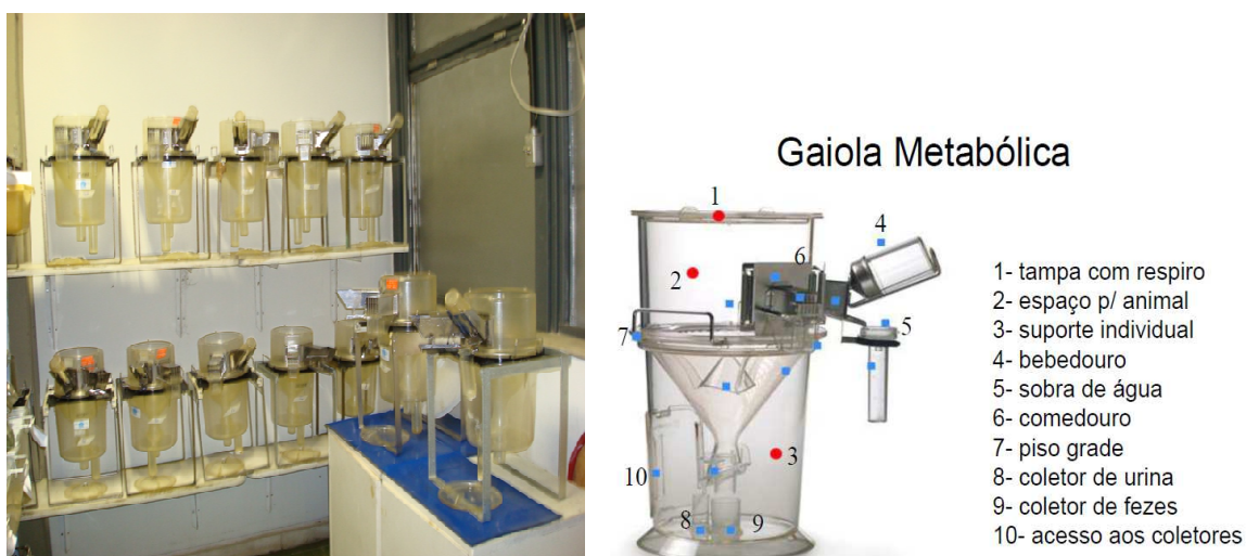
Figura 3. Fotografia de gaiolas metabólicas individuais (esquerda). À direita, figura esquemática de uma gaiola mostrando os seus componentes.
