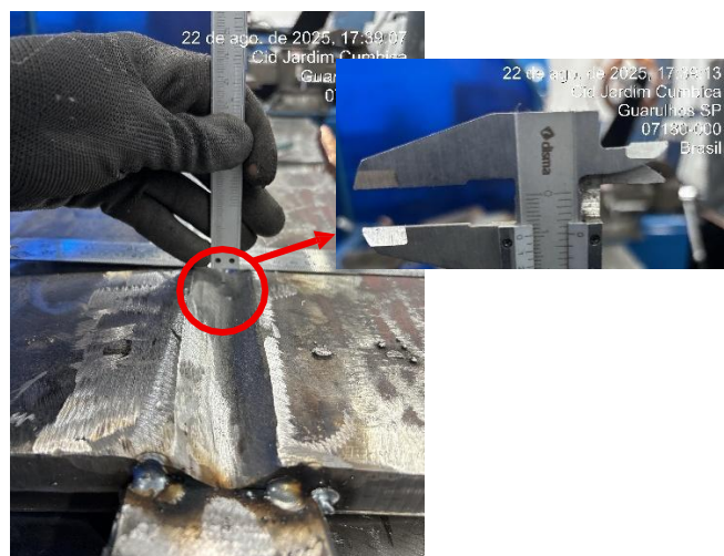
Figura 9 - Esmerilhamento para remoção da descontinuidade nos corpos de prova.
