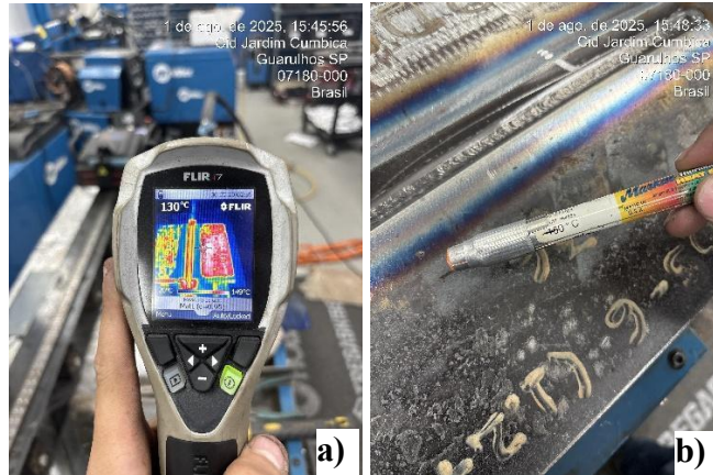
Figura 5 - Controle de Temperatura de Interpasse. a) Câmera Termográfica. b) Lápis Térmico
