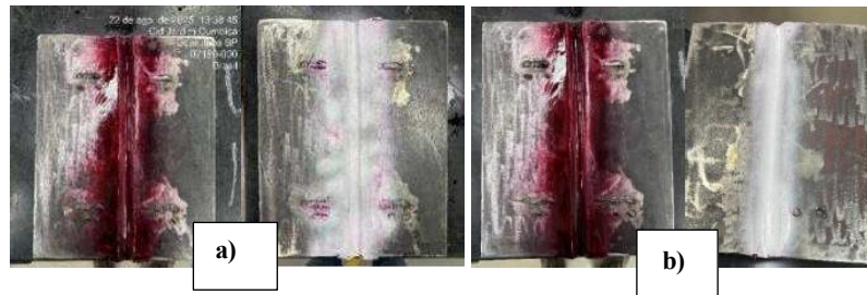
Figura 10 - Ensaio de Líquido Penetrante Após procedimento de Reparo, antes e após aplicação do relevador.
