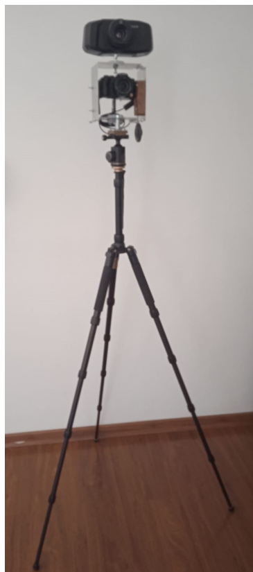
Figura 3.8: Estrutura mecânica para fixação das câmeras Specim e Panasonic montada em um tripé. Essa configuração foi utilizada nas incursões a campo.
