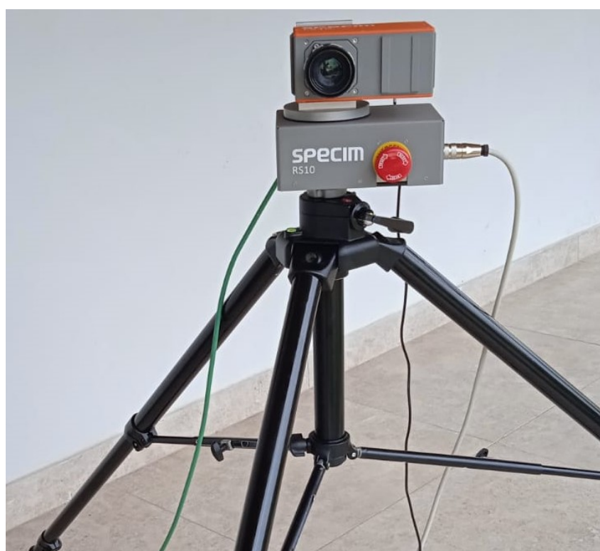
Figura 3.4: Câmera Hiperespectral FX-10: 448 bandas espectrais, faixa de 400 nm a 1000 nm, alojada sobre a unidade rotor RS-10.
