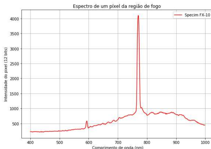
Figura 4.29: Espectro de um píxel na região da chama de uma imagem capturada com a câmera Specim FX-10. O pico de emissão em átomos de potássio destaca-se na figura, em 769,64 nm.
