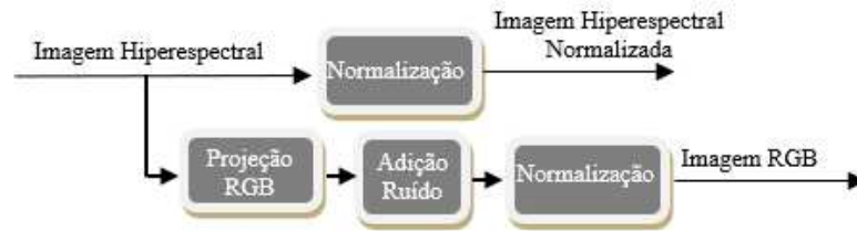
Figura 3.3: Etapa de pré-processamento no qual as imagens hiperespectrais são projetadas no espaço do sensor (RGB), sendo adicionado ruído devido à corrente de escuro e ruído fotônico.
