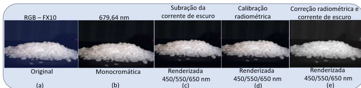
Figura 4.27: Imagem obtida com iluminação por lâmpada halógena. Em (a), imagem renderizada combinando o conteúdo espectral das bandas 450 nm, 550 nm e 650 nm. Em (b), imagem no comprimento de onda de 769,64 nm. Em (c), imagem renderizada após ser processada com subtração de corrente de escuro. Em (d), imagem renderizada após ser processada por calibração radiométrica. Em (e), imagem renderizada após ser processada por subtração da corrente de escuro e calibração radiométrica
