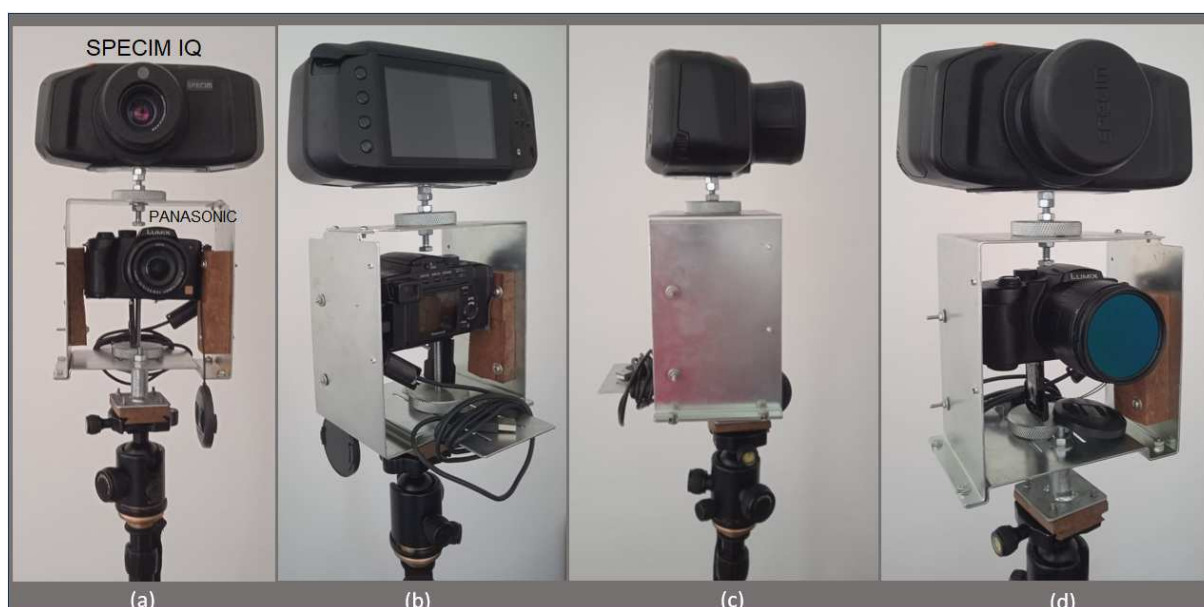
Figura 3.7: Estrutura mecânica para fixação das câmeras Specim IQ e Panasonic DMC-FZ5. A posição e orientação das câmeras se manteve fixa no processo de captura de imagens para composição da base de dados. Em (d) o detalhe da colocação de um filtro de infravermelho.
