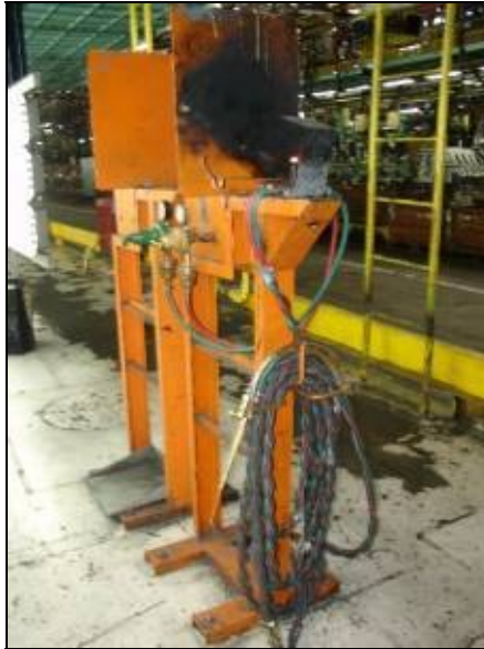
FIGURA 7– Estação de Maçarico
