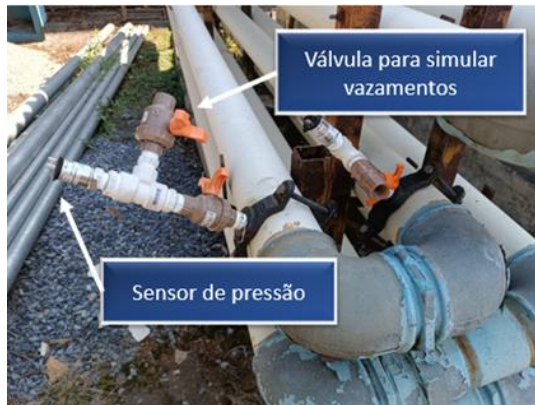
Figura 19: Exemplo do ponto de coleta de pressão e simulação de vazamentos
