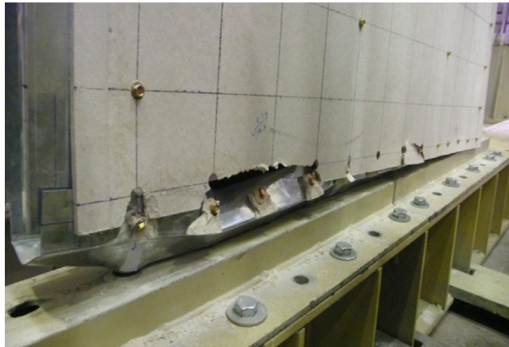
Figura 2.9 Fratura do revestimento na ligação com a guia inferior (LIN et al., 2014)
