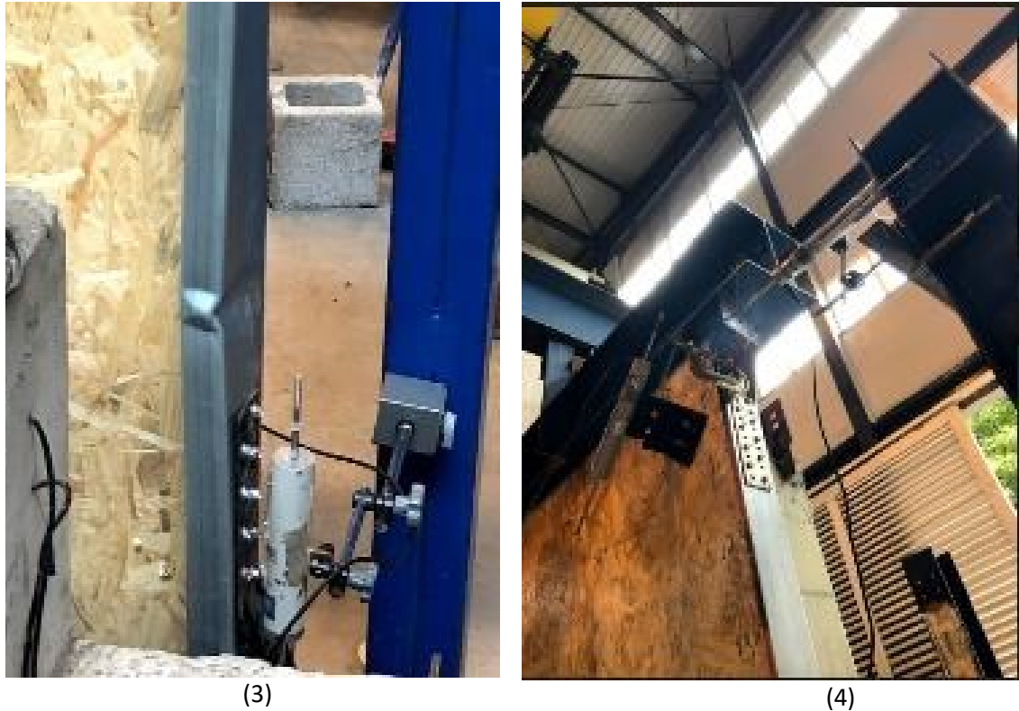
Figura 3.7 Fotos dos transdutores posicionados para realização dos ensaios. (1) DTs 1, 4 e 5; (2) DT Diagonal; (3) DT2; (4): DT3. (DE FARIA, 2023)
