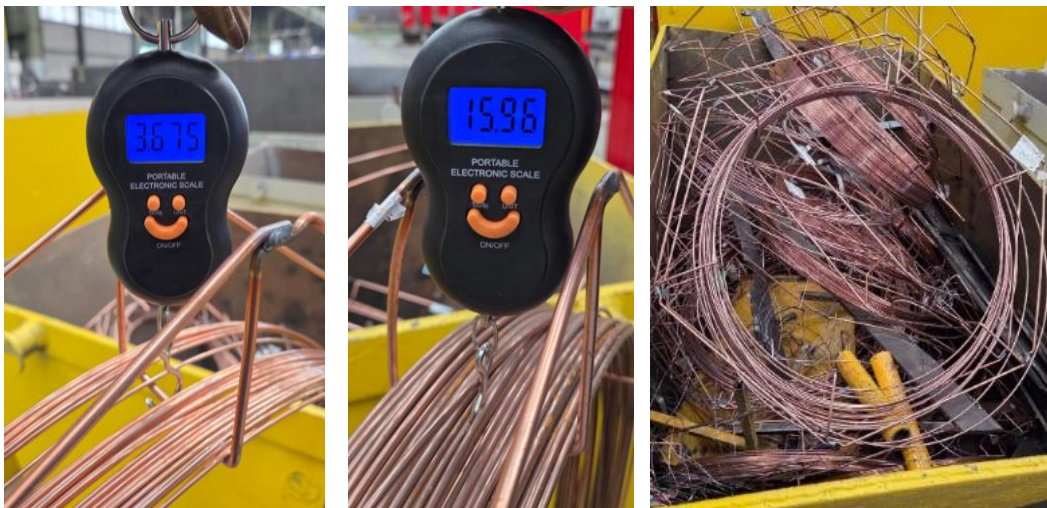
Figura 5 - Ilustração da pesagem do arame de 2,5mm, 4,0mm e descarte do consumível
