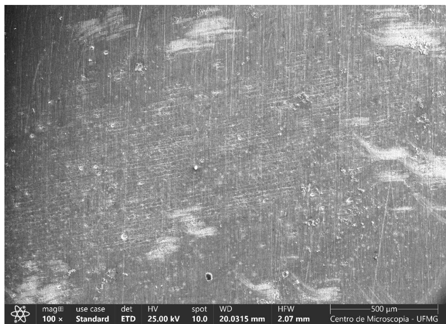
Figura A. 4 – Microscopia da amostra PHA com aumento de 100x.
