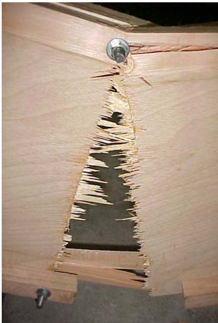
FIGURA 4.34 – Detalhe da ruptura do compensado
