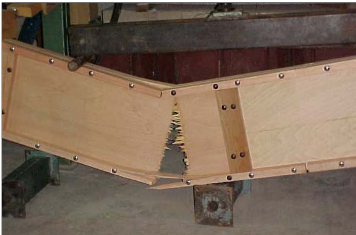
FIGURA 4.32 –Ruptura característica das vigas tipo "M"
