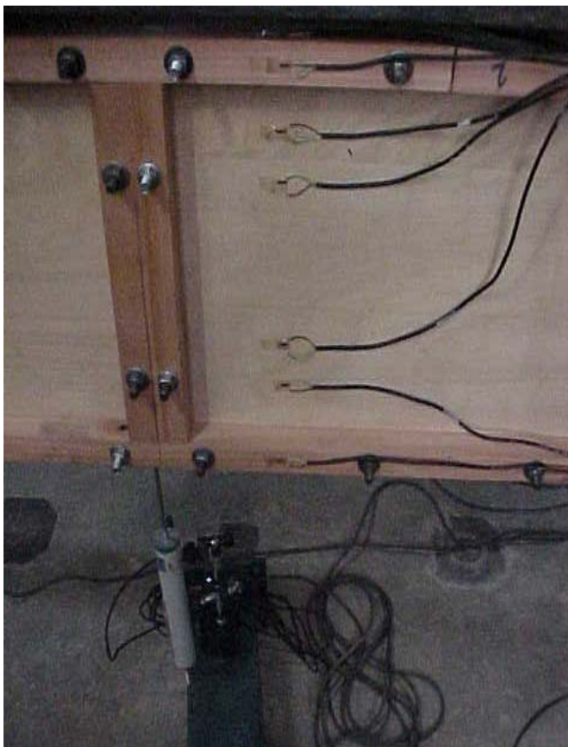
FIGURA 4.46 – Posicionamento dos extensômetros elétricos
