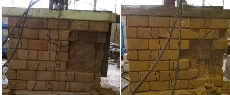
Figura 2.5 – Modo de falha de alvenarias em juntas secas.
