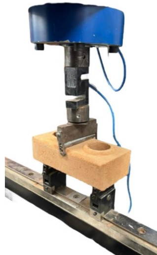
Figura 3.5 – Ensaio de flexão em três pontos.
