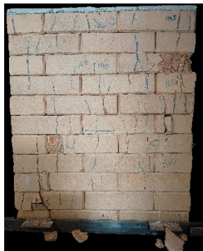
Figura 2.6 – Modo de falha de alvenarias em juntas de cola PVA.
