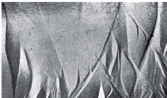
Figura 5 – Bandas de PLC formadas em uma liga de Al-Cu durante processos de conformação (16)
