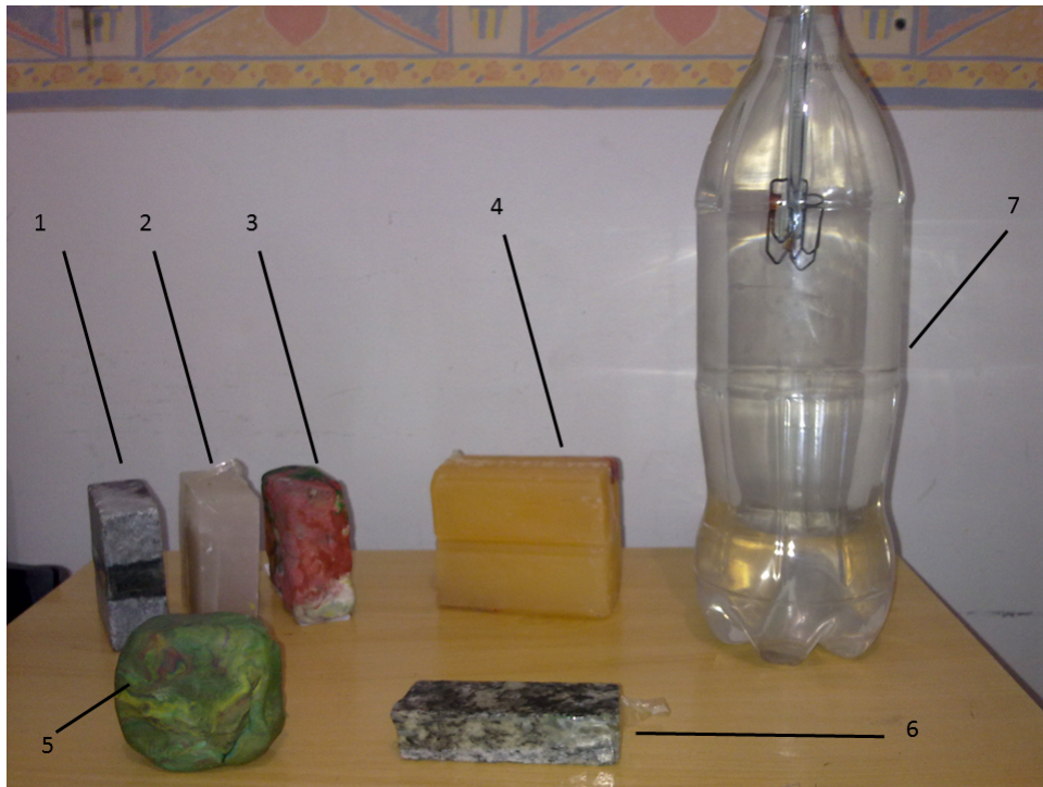
Figura 2: Materiais utilizados: 1 - Pedra A; 2 - Parafina; 3 - Massa de modelar A; 4 - Sabão; 5 - Massa de modelar; 6 - Pedra B; 7 - Ludião Bic (Submarino de caneta).
