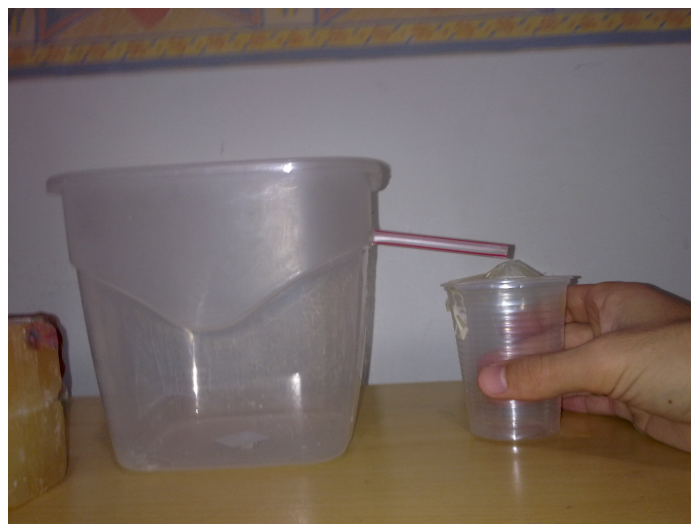
Figura 3: Vasilhame com saída lateral e copo coletor
