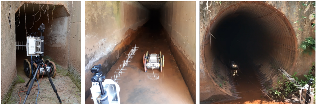
Figura 1 – EspeleoRobô sendo teleoperado durante atividades de inspeção em ambientes confinados. Fonte: [Campos et al., 2023a].
