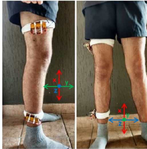
Figura 41 – Sensores fixados na coxa e canela do indivíduo
