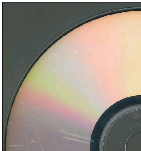
Figura 38 – Ranhuras na base de policarbonato 32
