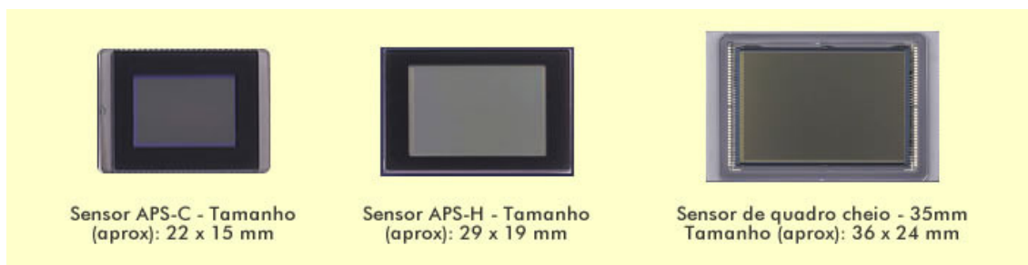
Figura 9 – Sensores CMOS fabricados pela Canon em diferentes tamanhos.
