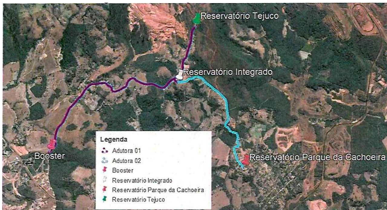
Figura 57: Modelo esquemático do Sistema de Abastecimento de Água Potável Integrado
