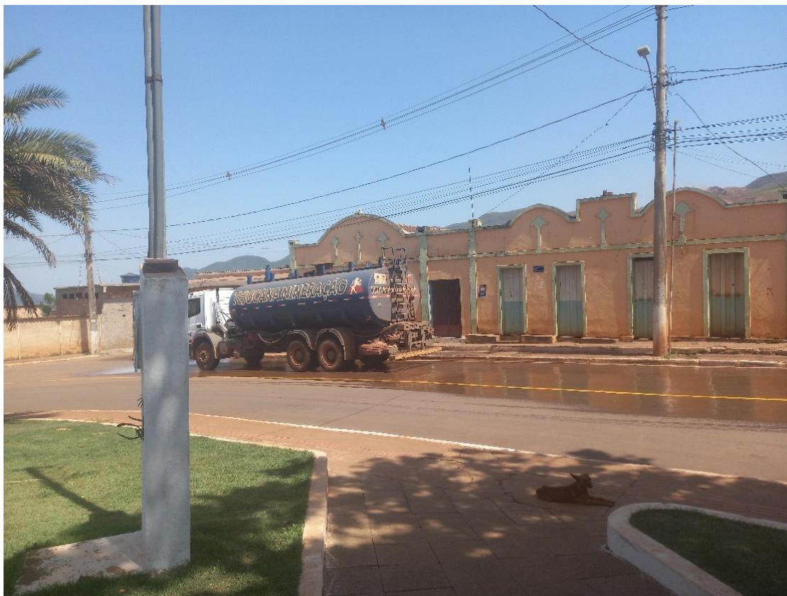
Figura 54: Caminhão-pipa da mineradora Tejucana jogando água nas ruas da comunidade do Tejuco para mitigar o excesso de poeira
