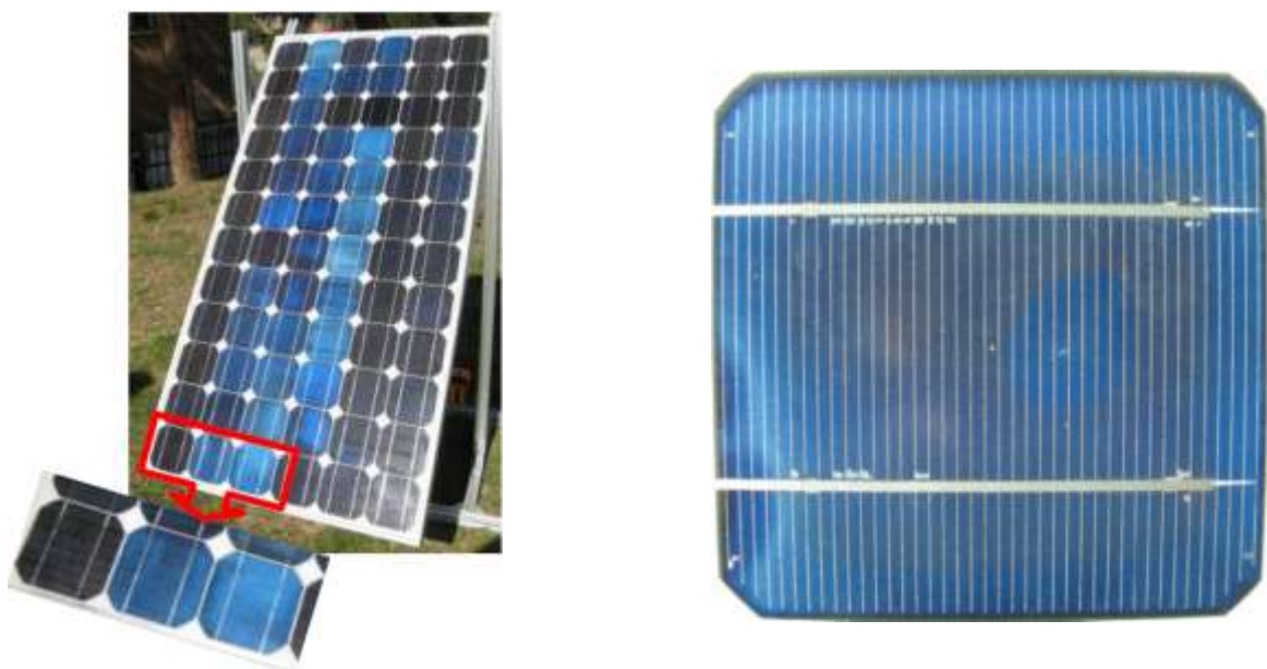
Figura 2.7 – Descoloração do revestimento AR, [52], [55].
