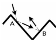
Figura 14 -Interreflexão provocada pela rugosidade do material
