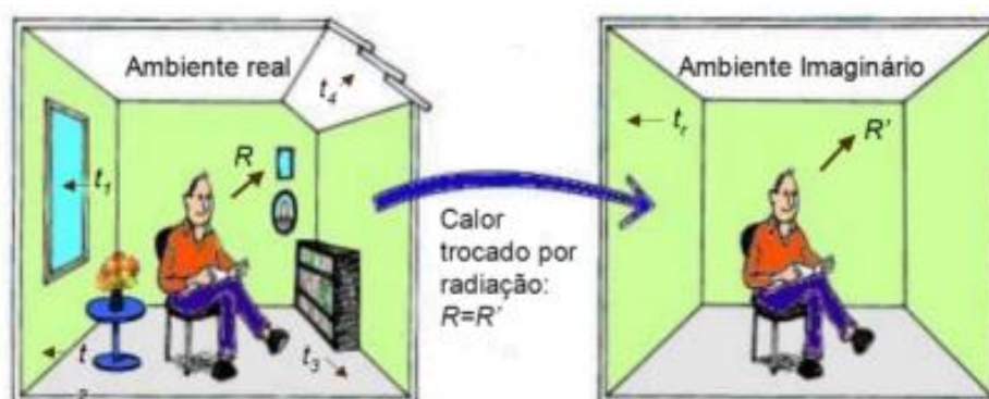
Figura 7- Trocas por meio da temperatura média radiante entre um ambiente real e o corpo humano e entre um ambiente imaginário e o mesmo corpo.
