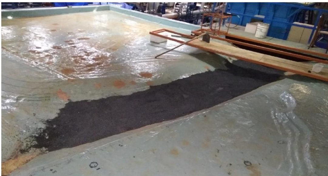
Figura 54 – Borracha disposta no modelo hidráulico reduzido previamente ao escoamento
