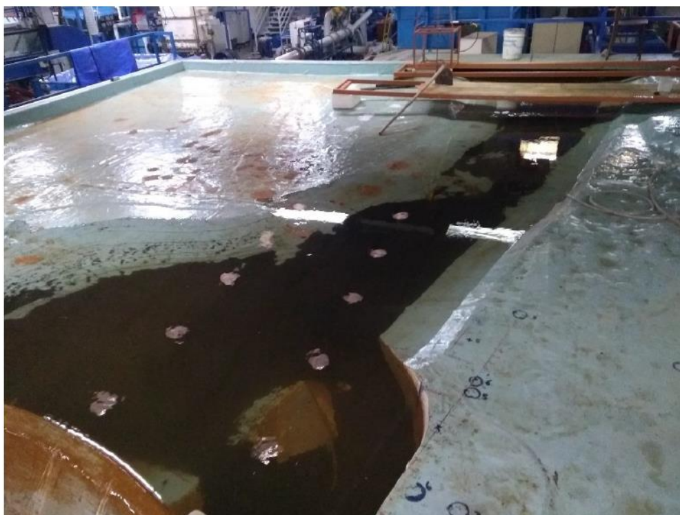
Figura 56 – Geometria de praia obtida ao final da simulação no modelo hidráulico reduzido
