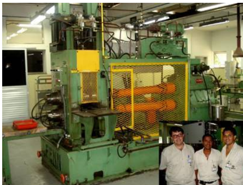
Figura 5.1 – Laminador FENN, laboratório de simulação termomecânica.
