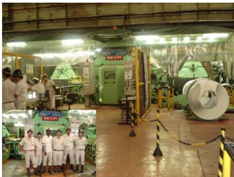
Figura 6.1 – Laminador de encruamento, área industrial da ArcelorMittal Inox Brasil.
