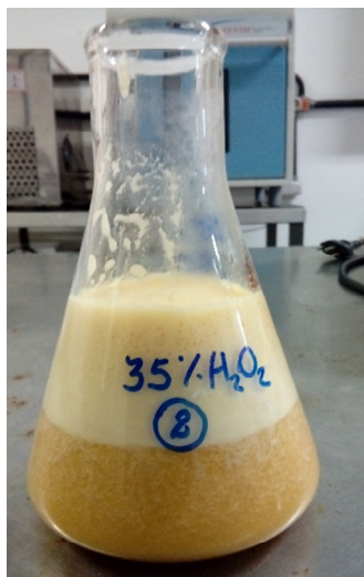
Figura 3.1: Foto de amostra proveniente de tratamento da borra de café com \text{H}_2\text{O}_2 alcalino.
