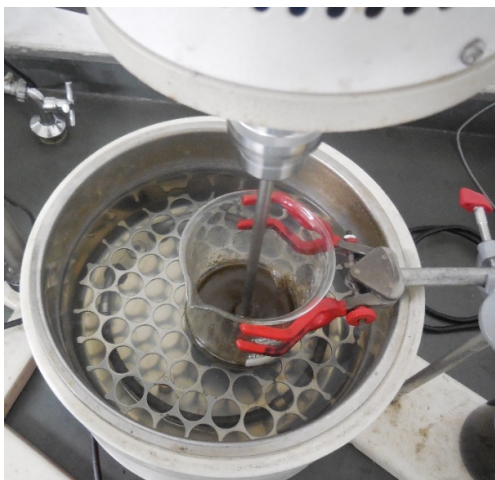
Figura 3.4: Foto de preparação do filme em banho maria e sob agitação mecânica.
