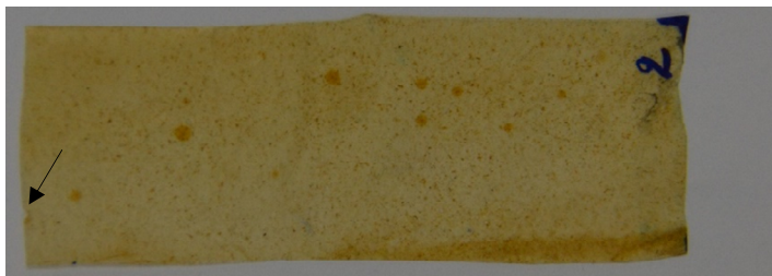
Figura 4.20: Foto de amostra F152, rompimento na inclusão.
