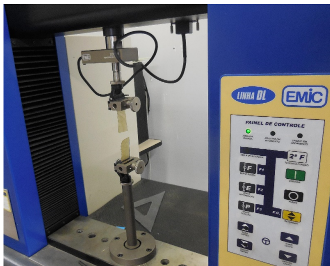
Figura 3.5: Foto do ensaio de tração, momento da ruptura do corpo de prova.
