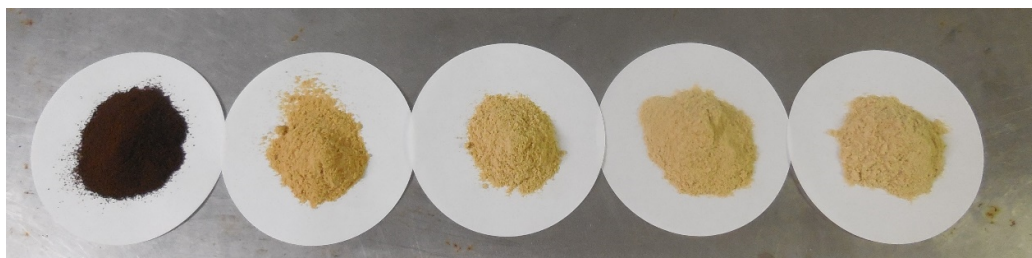
Figura 4.1: Foto da borra de café e dos materiais provenientes desta, representados nesta ordem da esquerda para esquerda para direita: borra de café, P15, P25, P35 e P45.
