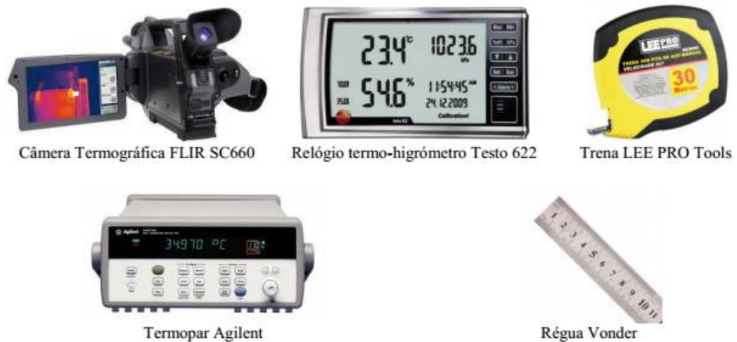
Figura 4.7: Equipamentos utilizados para as medições.
