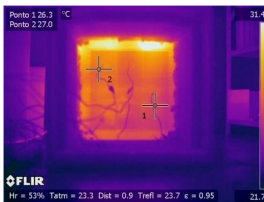
Figura 4.8: Termograma que demonstra o maior aquecimento na porção superior da amostra
