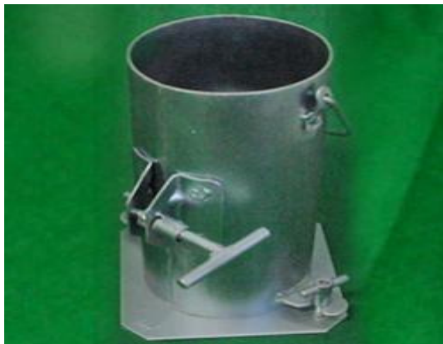
Figura 23: Forma para a moldagem dos corpos de prova
