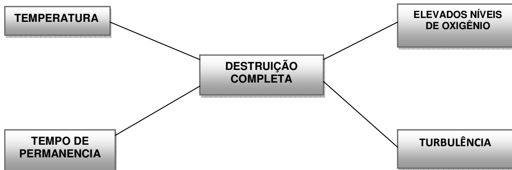
Figura 1: Condições necessárias para a incineração completa dos resíduos
