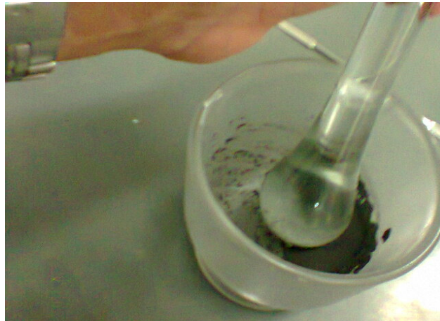
Figura 19 - Trituração do material para sua homogeneização
