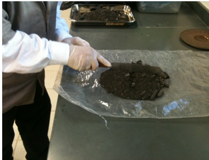
Figura 16 - Quarteamento da amostra de RSS – Homogeneização
