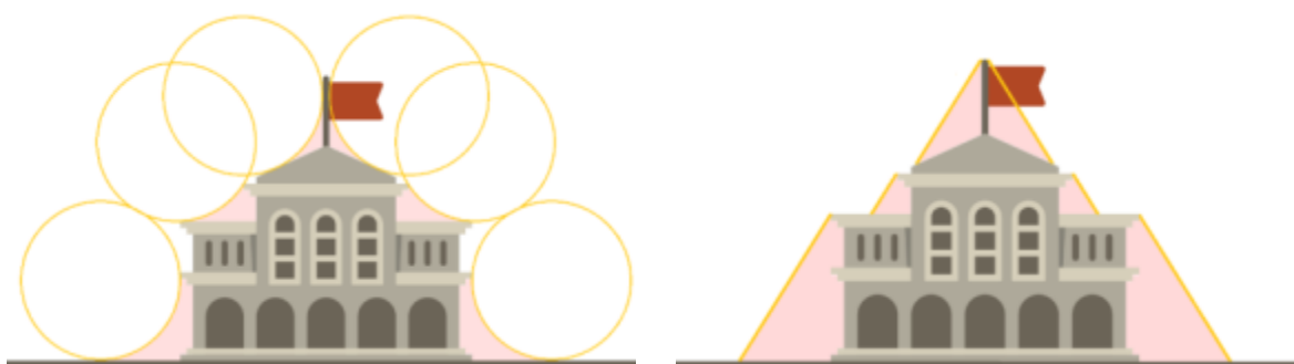
Figura 5 – Subsistema de captação isolado:
