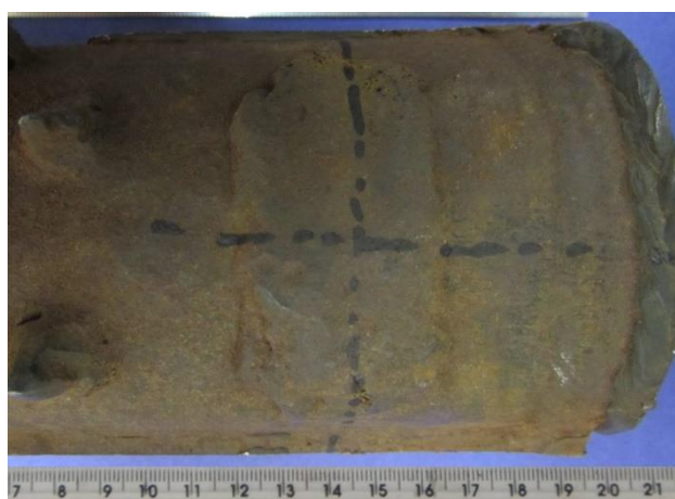
Figura 4-8 - Amostra 5: detalhe de onde foi feito o corte para o embutimento.
