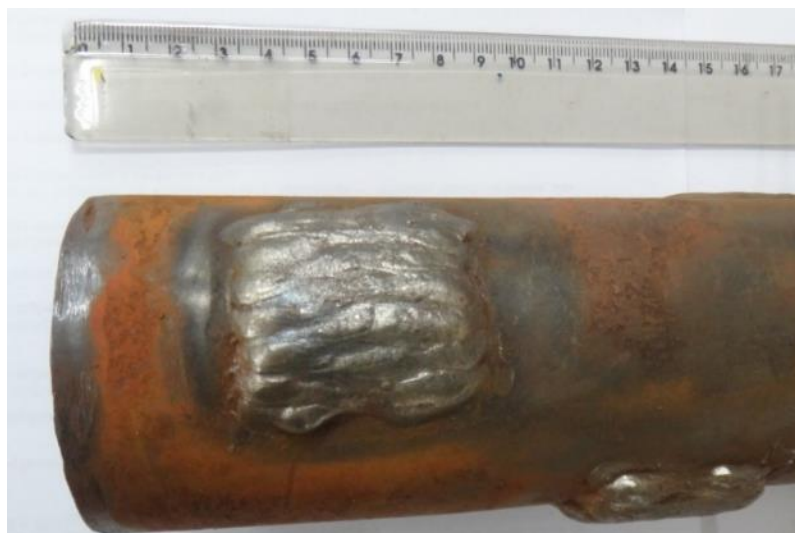
Figura 4-9 - Amostra 3: tubo novo da Amostra 1 que serviu de corpo de prova para fazer a reposição de espessura por soldagem.
