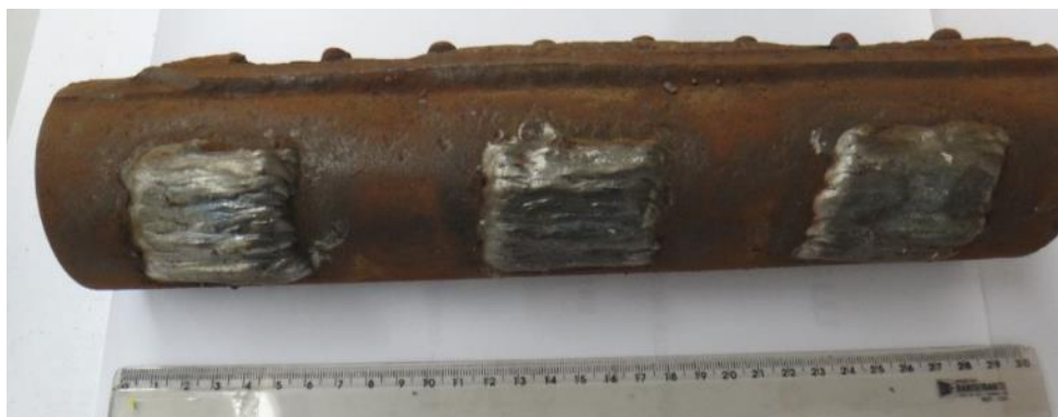
Figura 4-10 - Amostra 4: tubo usado da Amostra 2 que serviu de corpo de prova para fazer a reposição de espessura por soldagem.
