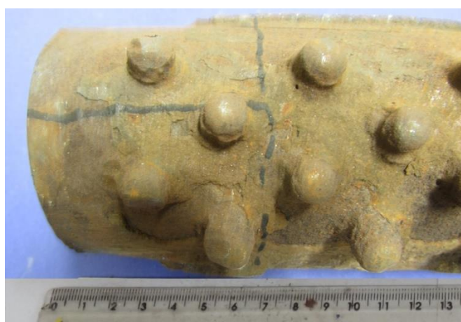
Figura 4-5 - Amostra 2: detalhe de onde foi feito o corte para o embutimento.
