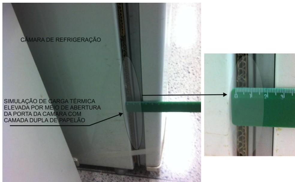
Fotografia 3 – Simulação de carga térmica elevada através de abertura da porta.
