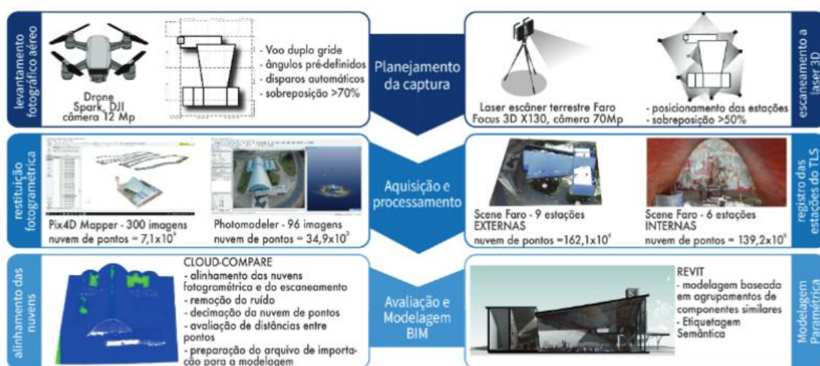
Figura 30 – Fluxo de trabalho para elaboração do Modelo HBIM
