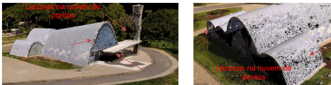
Figura 58 – Resultado da nuvem de pontos após processamento das imagens capturadas no voo planejado, realizado no dia 28/10/2021
