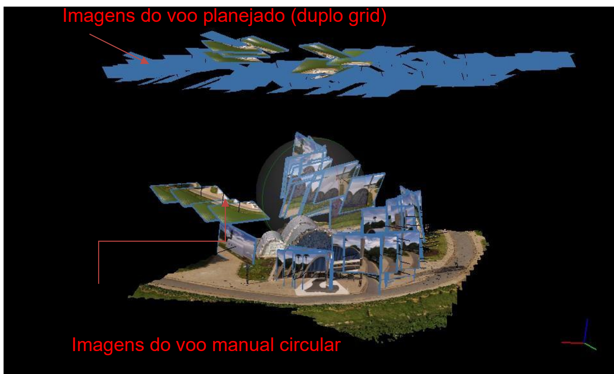
Figura 47 – processo da junção das imagens obtidas nos dois voos (duplo grid e manual) no programa Agisoft metashape
