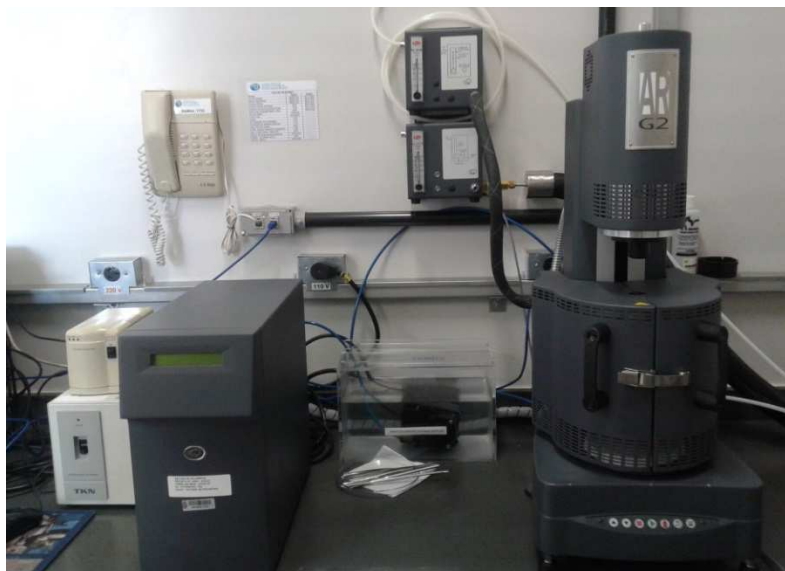
Figura 22 - Equipamento reômetro AR-G2 da TA Instruments
