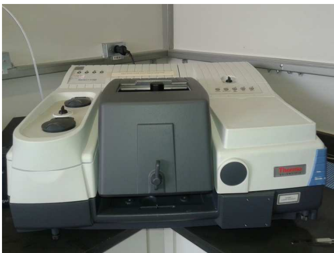
Figura 20 - Equipamento FTIR modelo Nicolet 6700 da Thermo Fisher SCIENTIFIC
