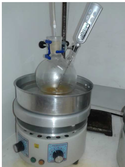
Figura 21 - Representação do sistema utilizado para síntese dos MIVs
