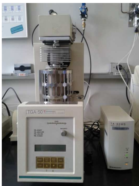
Figura 19 - Equipamento Shimadzu TGA-50
