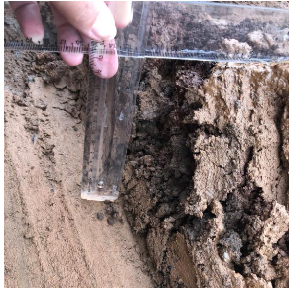
Figura 5.30 - Identificação de trilha de roda com profundidade 13cm, caracterizando o defeito estrutural como alta severidade.
